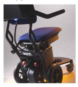
Freno regolabile per meglio adattarsi a tutti i tipi di scale Adjustable brake in order to better adapt to all types of stairs
