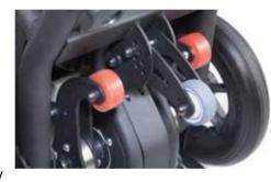
Freni di sicurezza disinseribili per facili spostamenti e attivabili automaticamente Disengaged safety brakes
